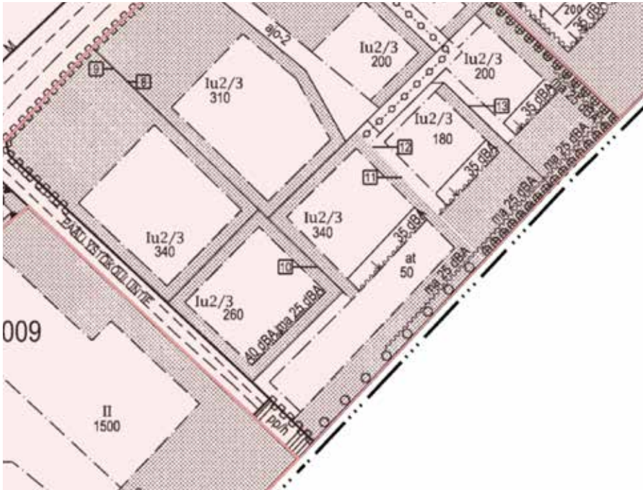
135. Ote ajantasa-asemakaavasta. Rakennettava tontti on numero 11. Kaava edellyttää päärakennuksen ulkoseinä- ja ikkunarakenteilta 35 dB:n melunsuojausta ja mutkittelevan viivan kohdalle Järvenpääntien varteen rakennettavaa 25 dB:itä suojaavaa, 3 metriä korkeaa rakenteellista umpinaista meluestettä. Lisäksi aidan tien puolelle on osoitettu paikka istutettavalle puuriville.
